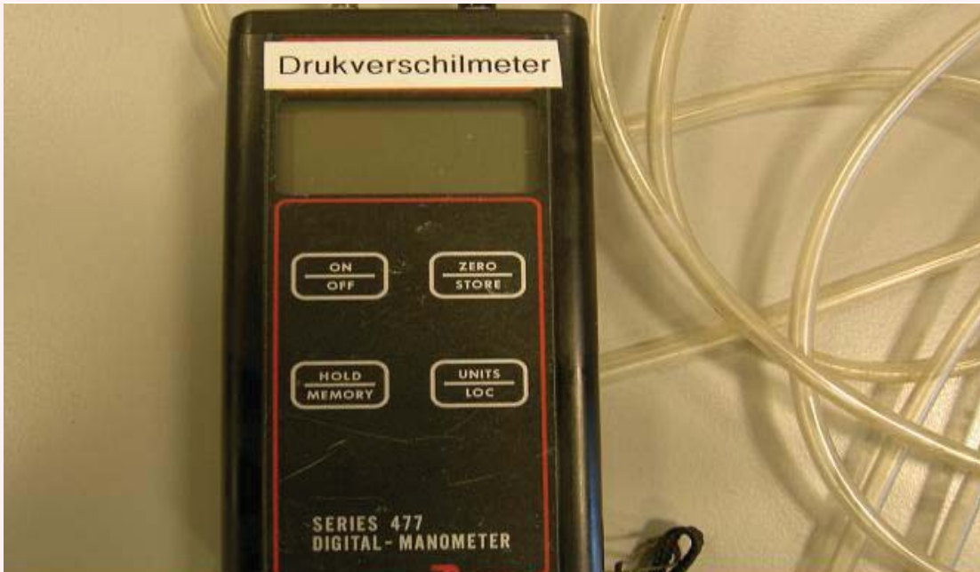
[사진 47] 음압측정기는 돈사의 압에 따라 환기량을 계산하기위해서 사용된다.
